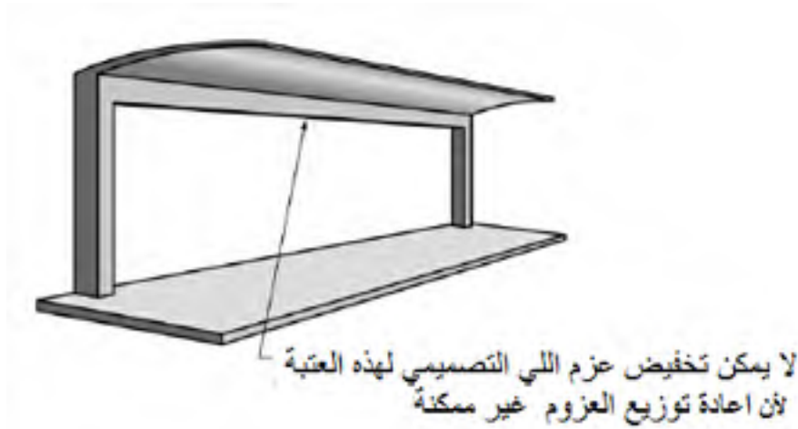
شكل (4-8) لا يمكن تخفيض عزم اللي في هذا الشكل
